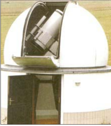
Abb. 4: Für die Volkssternwarte in Drebach (Sachsen) hat Baader Planetarium eine komplette Beobachtungsstation mit einem 0.52-m-Ritchey-Chretien-Spiegel und einer 4-rn-Kuppel hergestellt und montiert. (Bild: Baader Planetarium)
